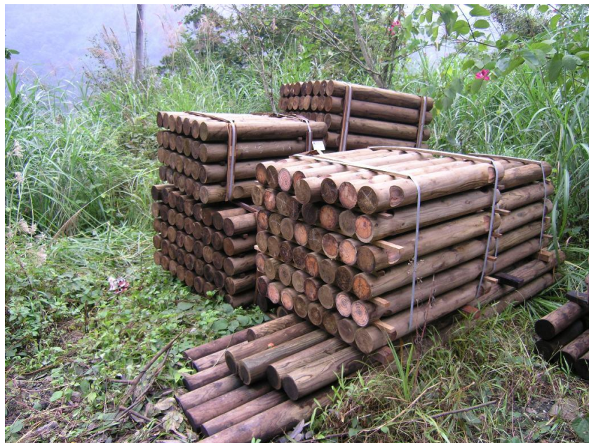
照片 3、八面壓縮圓木樁之防腐處理材
